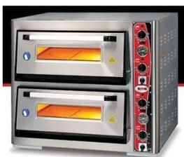
PIZZAOFEN,<br>Kammern KOMPLETT MIT<br>SCHAMOTTSTEIN VERKLEIDET,<br>Beleuchtung je Backkammer,<br>2 Kammern, 4+4 Pizzen Ø 33 cm<br>Innenraum: BTH: 670x680x150 mm<br>Temperaturregelung getrennt<br>für Unter- u. Oberhitze,<br>separat regelbar 85° - 450°C,<br>incl. Thermostat und<br>Hauptschalter je Kammer<br>Leistung: 10kW, 3NAC, 400 V<br>Absicherung: 25A<br>Außenmaß: BTH:970x890x760 mm<br>(ohne Türgriff)<br>Außenmaß: BTH:970x960x760 mm<br>(mit Türgriff)<br>€ 1.998,00 | € 1.998,00 |
