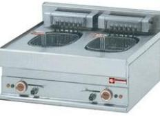
ELEKTRO-FRITEUSE<br>Ausführung: Tischgerät,<br>Heizkörper zur Reinigung<br>hochstellbar.<br>2 Becken: à 10 Liter<br>mit: Sicherheitsthermostat<br>Material: Chromnickelstahl<br>Anschlußwert: 400V / 15kW<br>ABM: B 700 T 650 H 280 mm<br>€ 1.698,00 | € 1.698,00 |
