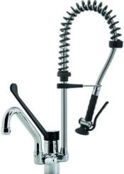
Geschirrbrause Langhebel<br>extraflache Ausführung nur<br>ca. 650 mm hoch.<br>Einhebel-Einlochatterie<br>mit separater Befüllatterie<br>Auslauflänge: 250 mm<br>Loch 32 mm                                                                                                                                                                       |            |
