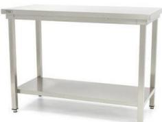
ARBEITSTISCH<br>Tragfähigkeit der<br>Arbeitsplatte: 150-200 kg<br>Füße aus Vierkantrrohr 40x40mm,<br>höhenverstellbar.<br>Material: Edelstahl<br>Bausatz, Lieferung erfolgt<br>zerlegt. Sehr einfache Montage                                                                      |            |
