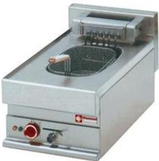
Elektro-FRITEUSE<br>Ausführung: Tischgerät<br>1 Becken: à 8 Liter<br>mit: Sicherheitsthermostat<br>Material: Chromnickelstahl<br>Anschlußwert: 400V / 7,5 kW<br>ABM: B 400 T 650 H 380 mm<br>€ 988,00                                                | € 988,00   |
